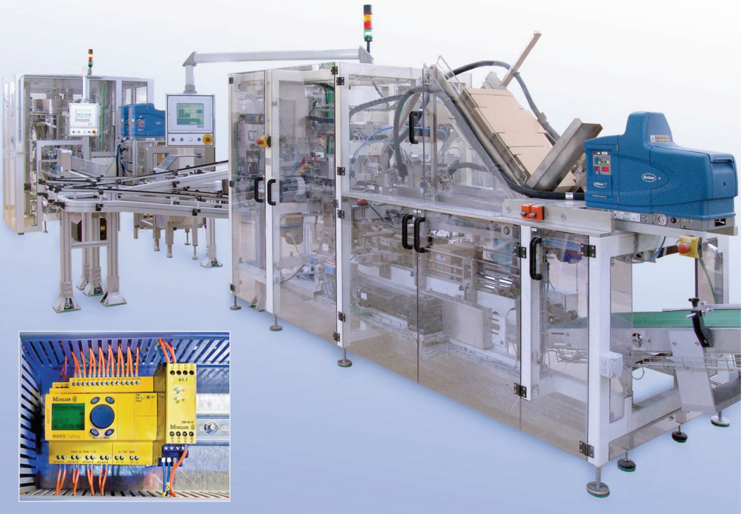
easySafety überwacht alle Tür- und Not-Halt-Kreise und kommuniziert über Profibus DP mit dem Motion-Control-System.
